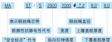
GX 系列钢丝绳芯输送带主要技术参数
